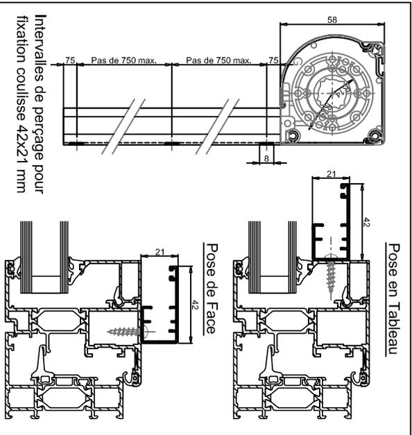
Intervalles de perçage pour fixation coulisse 42x21 mm
