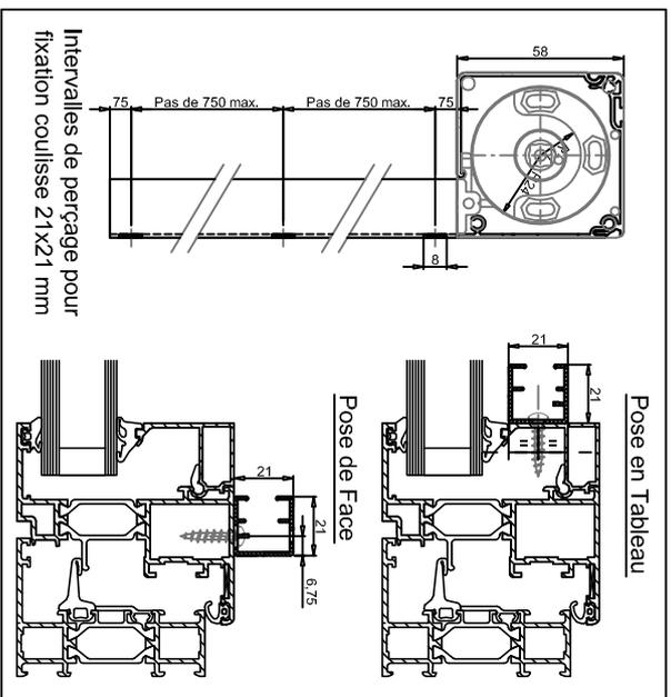
Intervalles de perçage pour fixation coulisse 21x21 mm
