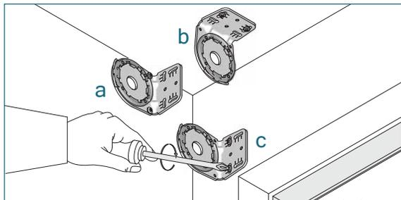
1/a: pose tableau b: pose plafond c: pose de face
