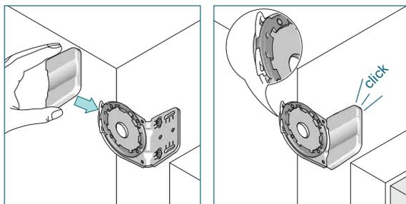
2/Ouvrez les 2 attaches du support. Clipsez les caches vis.
