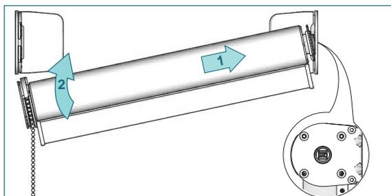
3/Placez le ressort de compression dans le support, remonter le store en face du support du mécanisme.
