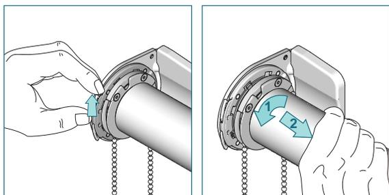
Ouvrez les 2 attaches du support. Tournez le rouleau vers vous afin de libérer les crans du mécanisme.
