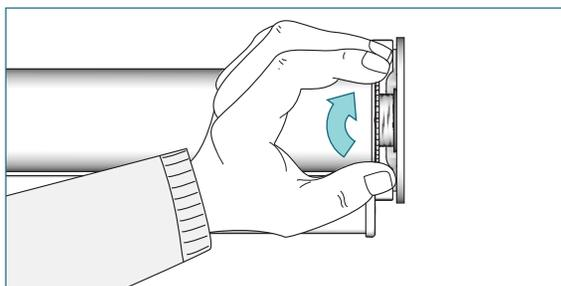
5/Serrez l'écrou du ressort de compression pour l'emmener en butée côté tube.
