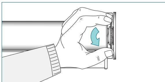
Desserez l'écrou dentelé du ressort de compression.
