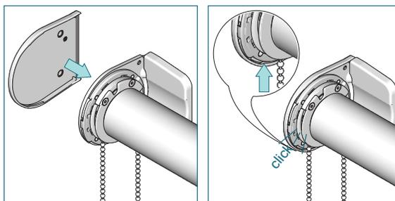
6/Clipsez les caches, assurez vous préalablement que les attaches soient correctement verrouillées.
