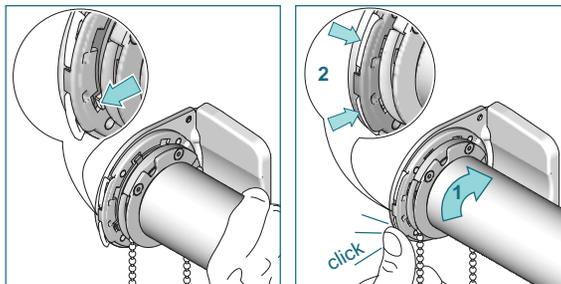
4/Placez les ergots du mécanisme dans les empreintes du support. Tournez le mécanisme pour ne plus voir les ergots. Fermez les attaches du support pour verrouiller le mécanisme.
