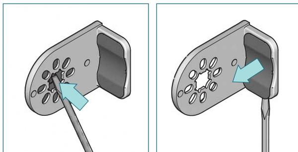
Dans le cas de supports décoratifs, retirez les capuchons en les pressant de l'intérieur et retirez les caches vis à l'aide d'un tournevis.
