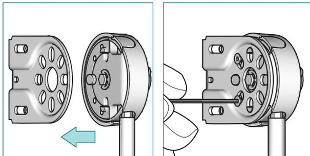
Positionnez le treuil à manivelle sur le support et fixez-le à l'aide des deux vis fournies.
