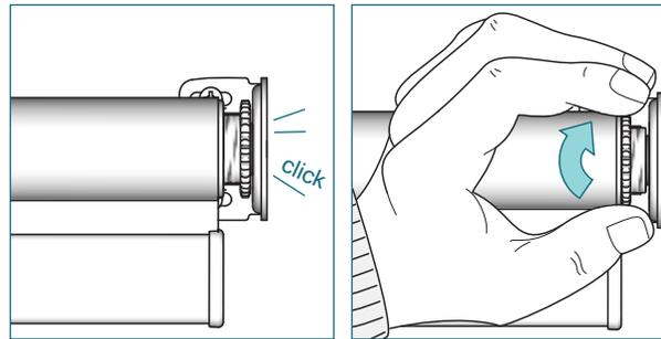
Encliqueter le store sur le support. Fixez le store en tournant l'écrou dentelé contre le support.
