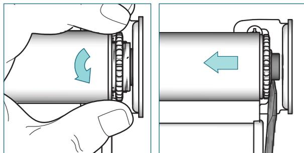
Desserrez l'écrou dentelé. Glissez un tournevis entre le support et le palier et poussez le palier vers le côté de manœuvre.
