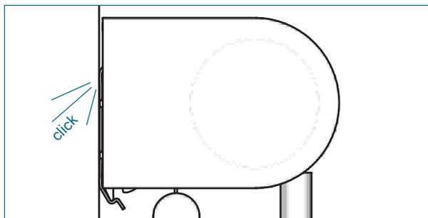
Poussez le profil de montage contre les clips jusqu'à leur verrouillage.
