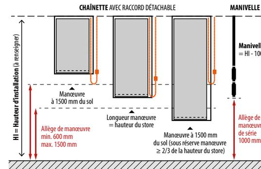
Si la hauteur d'installation est inconnue, la hauteur de manœuvre sera de 1000 mm.
