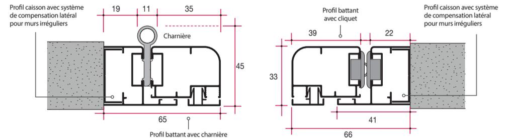
Compense jusqu'à 8 mm en largeur par côté
